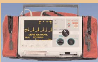
Abb. 4. Moderner biphasischer Defibrillator (Zoll M-Serie).
